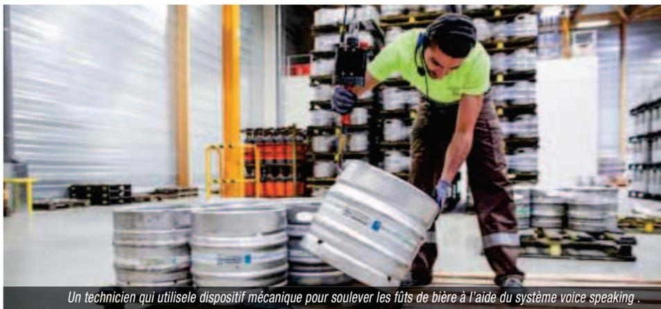
Un technicien qui utilise le dispositif mécanique pour soulever les fûts de bière à l'aide du système voice speaking.
